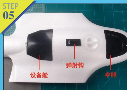
例图5-6：用胶水涂抹安装伞舱、弹射钩、设备舱、电机座和电池板。
