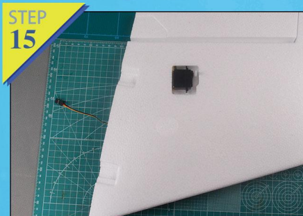
例图15-16：安装副翼舵机，先将线从侧面孔槽中穿出来，再固定粘黏舵机。
