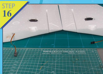
例图15-16：安装副翼舵机，先将线从侧面孔槽中穿出来，再固定粘黏舵机。
