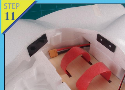
例图11-12：用胶水安装舱盖和机身上的塑胶件。
