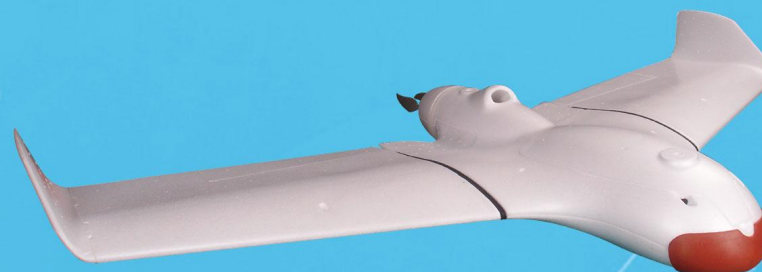
例图21-22：将机翼安装在机身上（安装好的机翼和机身通过碳管和快装件对接），完成安装。
