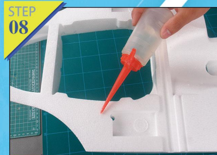
例图7-8：用胶水涂抹上下机身接触面，涂抹完成后将其晾置大约2分钟，等待胶水不粘手。
