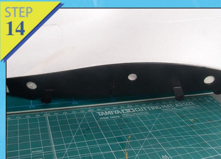
例图13-14：用胶水粘合机头保护罩；将碳管插入机身，再将机身左右两边快装件粘黏固定。
