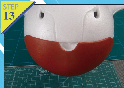
例图13-14：用胶水粘合机头保护罩；将碳管插入机身，再将机身左右两边快装件粘黏固定。
