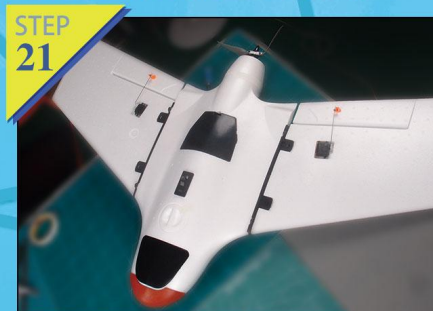
例图21-22：将机翼安装在机身上（安装好的机翼和机身通过碳管和快装件对接），完成安装。
