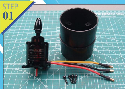
例图1-2：电机用4颗自攻螺丝固定在马达座。
