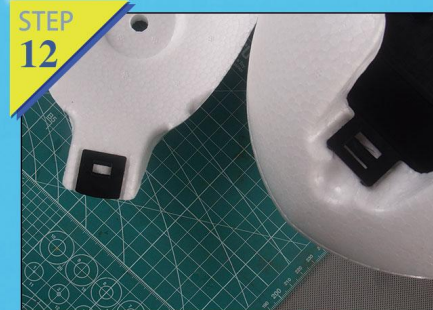
例图9-10：机身在粘黏完成之前，可以将您所需的FPV设备安装在机身预留的位置内，最后再合拢机身，这样可以使设备不外漏；粘合机身时注意将上下机身对齐。
