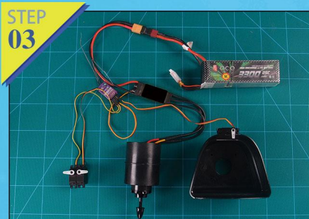
例图3-4：接上电调和接收器，将舵机归位、确定电机顺时针转，设备舱木板用螺丝固定好，方便更换接收设备。
